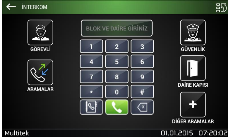
Resim 7: “DAİRE KAPISI” simgesine dokunarak iç kapiya bağlanma
